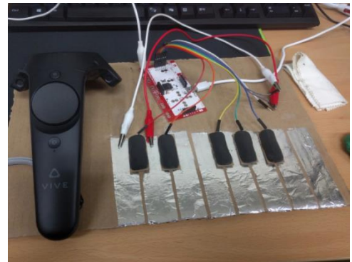
그림 3 은박지와 전도성 점토로 제작한 피아노 모델
