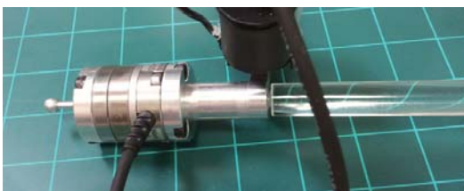
[그림 2] 구형 탐침과 NANO25 힘/토크 센서
