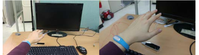
그림 2. 제스처 인터페이스 실험 환경 및 진동 피드백 장치
